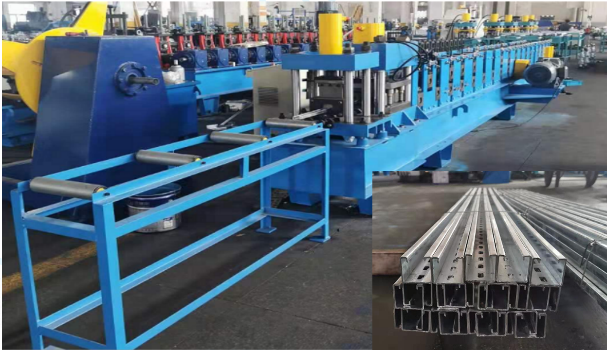
Rail 41x41 (Epaisseur 1,5/2/2,5 mm)
